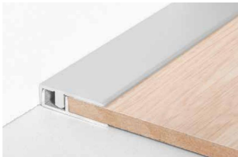
Baufloor®, per una posa a regola d'arte, consiglia l'utilizzo di un profilo perimetrale qualora s'intenda non utilizzare il battiscopa Decor Plus. Profilo in alluminio anodizzato, adatto per pavimenti in laminato h 7 e 8 mm da utilizzare con il profilo base. Colore argento.
