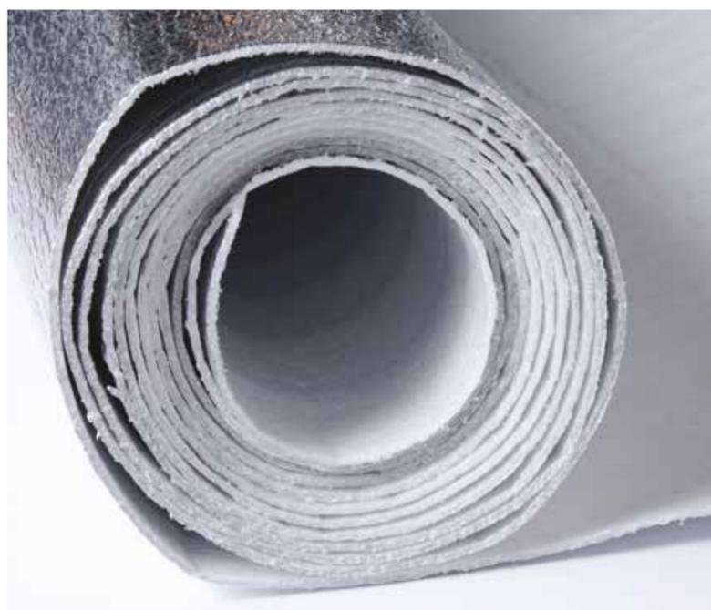
Isolante acustico a base polipropilenica ad alta densità (35 kg/m<sup>3</sup>), prodotto a cella chiusa senza utilizzo di CFC, HCFC, elasticizzanti, metalli pesanti e altre sostanze pericolose. Riduce il riverbero (15%), ottimo isolamento acustico (>58 dB) e grazie all'accoppiamento con foglio di poliestere alluminizzato garantisce una buona barriera contro l'umidità dal basso. Materiale da posare con la parte in alluminio verso l'alto.
