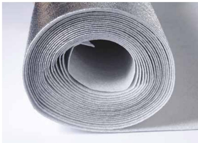
Foglio PE estruso a cella chiusa prodotto senza utilizzo di CFC, HCFC, elasticizzanti, metalli pesanti e altre sostanze pericolose. Riduce il riverbero (8%), buon isolamento acustico (>19dB) e grazie all'accoppiamento con foglio di poliestere alluminizzato garantisce una buona barriera contro l'umidità dal basso. Materiale da posare con la parte in alluminio verso l'alto.
