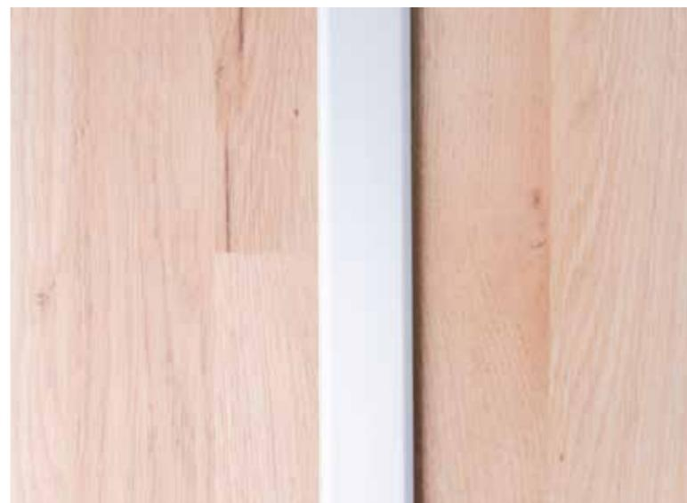
Baufloor®, per una posa a regola d'arte, consiglia l'utilizzo di un profilo di dilatazione ogni 8/10 mt di pavimento in laminato posato nel senso lungo. Profilo in alluminio anodizzato, adatto per pavimenti in laminato h 7 e 8 mm da utilizzare con il profilo base. Colore argento.
