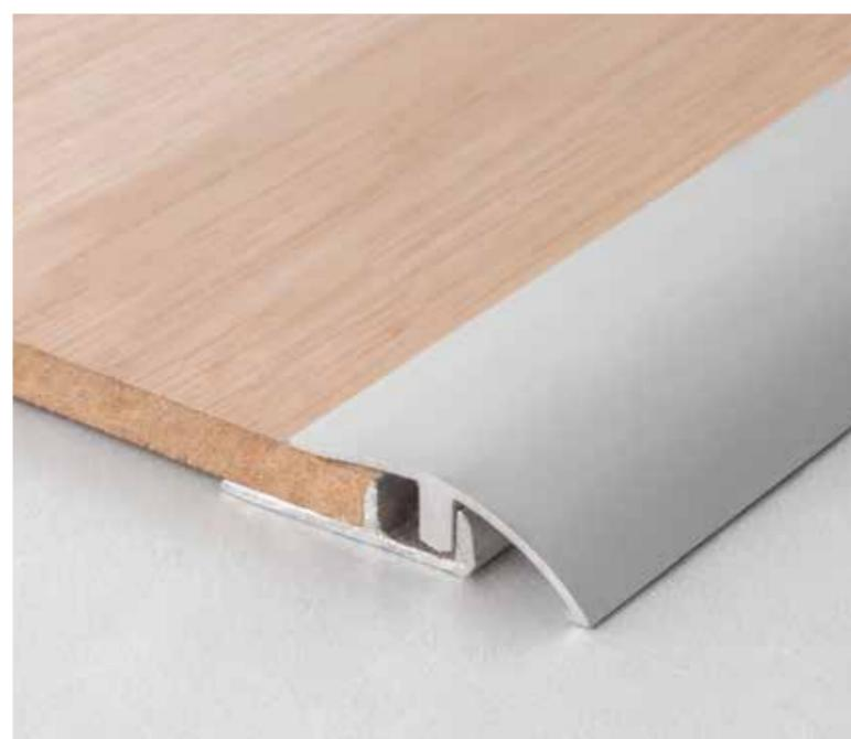
Baufloor®, per una posa a regola d'arte, consiglia l'utilizzo di un profilo di partenza qualora s'intenda far coesistere il pavimento esistente con il pavimento in laminato sovrapposto. Profilo in alluminio anodizzato, adatto per pavimenti in laminato h 7 e 8 mm da utilizzare con il profilo base. Colore argento.
