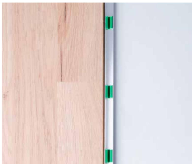
Profilo in alluminio necessario per l'installazione di tutti gli altri profili (dilatazione, partenza e perimetrale). Posizionando le clip verdi all'interno del profilo di base ogni 25/30 cm, sarà possibile inserire il corrispondente profilo superiore semplicemente battendolo con un martello in gomma. Profilo adatto per pavimenti in laminato h 7 e 8 mm.
